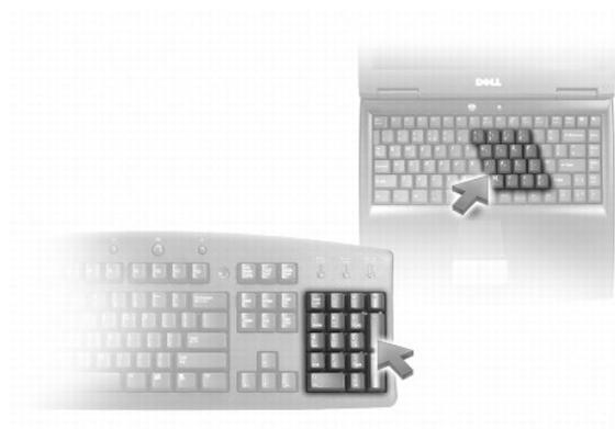
Der numerische Tastenblock funktioniert genauso wie der numerische Tastenblock auf einer externen Tastatur. Jede Taste auf der Tastatur besitzt mehrere Funktionen. Die Zahlen und Symbole des numerischen Tastenblocks sind in blauer Schrift rechts auf den entsprechenden Tasten angegeben. Um eine Zahl oder ein Symbol einzugeben, halten Sie <Fn> gedrückt und betätigen die gewünschte Taste.
