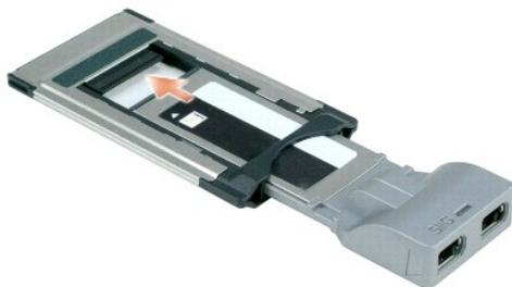
2. Schieben Sie den Adapter in den Steckplatz, bis er ordnungsgemäß im Anschluss eingerastet ist.
