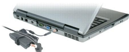
Der Netzadapter wandelt Wechselstrom in den vom Computer benötigten Gleichstrom um. Sie können den Netzadapter bei ein- oder ausgeschaltetem Computer anschließen.
