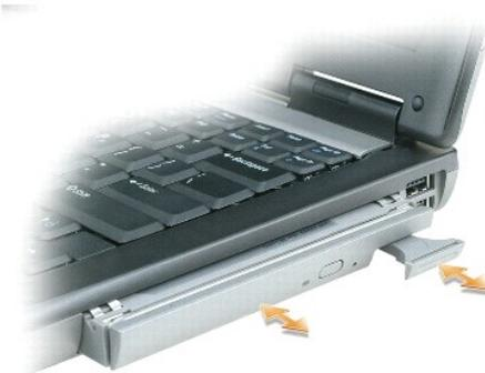
5. Schieben Sie das neue Gerät in den Modulschacht, bis es hörbar einrastet.
